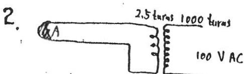
약간의 전찰력이 있는 학생이라면 실천실에서 접착언도 (soldering gun)를 사용할 때 다음과 같은 사실을 발견할 수 있을 것이다. 즉 그림에서와 같은 원형 (ring type) 구리 tip의 안쪽면에 붙어 있는 납이 녹으면 tip은 흐르는 전류에 의해 환의 외부(바깥쪽)로 밀려난다. 이와 같은 사실을 설명하고자 아래의 순서를 따라서 생각해 보기도 한다. 다음 물음에 답하라.
