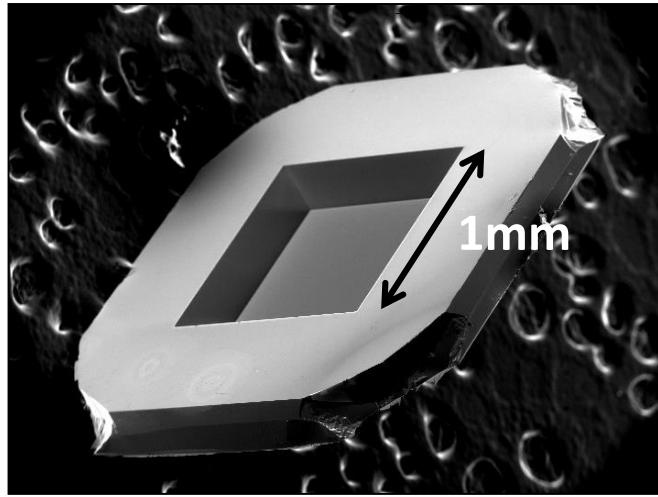
High Q  $\text{Si}_3\text{N}_4$  membrane,  $1 \text{ mm} \times 1 \text{ mm} \times 50 \text{ nm}$
